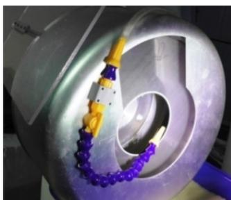
**Резка заготовок на пластины** осуществляется внутренней режущей кромкой отрезного алмазного круга АВРК 305x100x0,25x50 АСНН 60/40 1,8 карат или 80/60 в зависимости от твердости обрабатываемого материала. Станок Кварк-100 нарезает пластины с высокой точностью и минимальной потерей материала.
