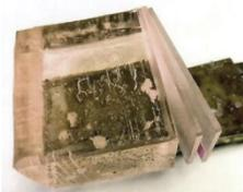
**Резка** заготовок материала осуществляется **внутренней режущей кромкой** вращающегося алмазного диска. Максимальный характерный размер-диаметр заготовок в плоскости реза **до 80 мм**, ограничение длины заготовки **80 мм**. Станок «КВАРК-100» работает **в ручном и автоматическом режиме** и имеет преимущества по сравнению со струнными, лентопильными и маятниковыми аналогами.
